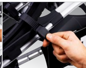
Felgenhalter mit komfortabler Ratschenfunktion mit Schnellverschluss für einfache, schnelle und stabile Befestigung der Räder.
